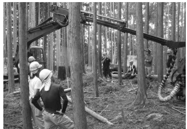
高性能林業機械による造材、集材
